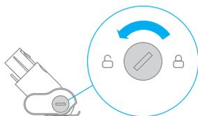
2. После разблокировки снимите ролик с насадкой с щетки, а затем промойте и прочистите.
