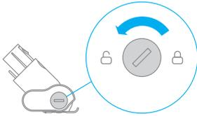
2. Nachdem Sie Rollbürste entriegelt haben, entfernen Sie diese von der elektrischen Mini-Bürste. Spülen und reinigen Sie die Rollbürste.
