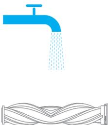
4. После промывки тщательно высушите роликовую щетку в вертикальном положении в хорошо проветриваемом месте как минимум в течение 24 часов.
